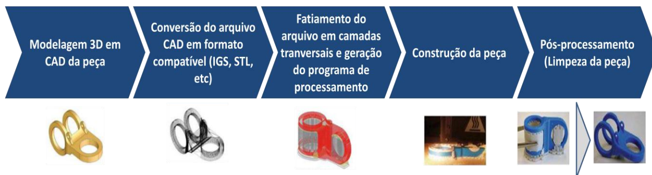
Figura 26 - Passos para construção de uma peça por prototipagem rápida
