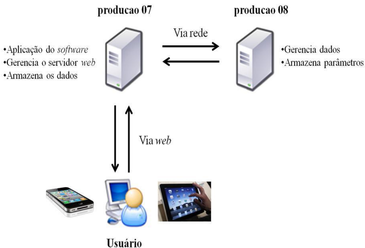
Figura 42 - Funcionamento do Windchill com domínio público
